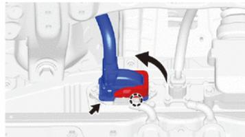
i. 推动连接器锁的同时移动锁杆，并断开电动机室主线束连接器。
